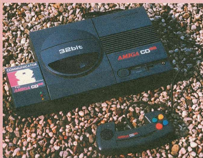
Interface: Der Communicator macht das CD 32 zum CD-Laufwerk, das man mit jedem Amiga verbinden kann
