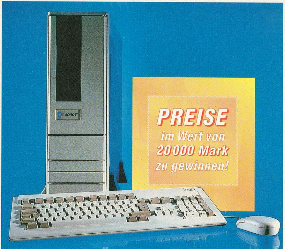
Amiga 4000 Tower: Die High-End-Maschine mit 68040-CPU ist der Traum eines jeden Amiga-Fans. Der Tower bietet fünf Zorro-II/III- und vier PC/AT-Steckplätze. Zusätzlich gibt's zwei Videoslots und einen SCSI-Controller onboard. gestiftet von: Commodore Büromaschinen GmbH
