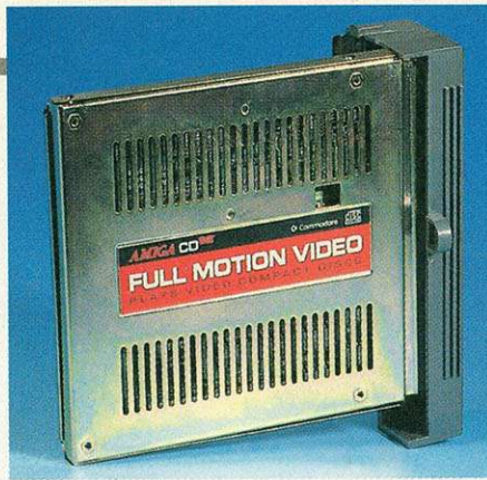
Full Motion Video: Mit dem neuen Steckmodul für Amiga CD 32 kann man jetzt auch Videos abspielen
