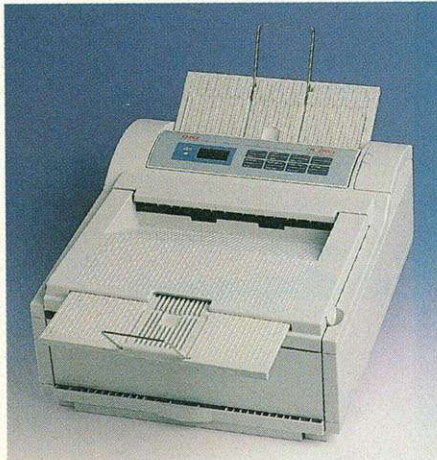
OKI 400ex: Der Vier-Seiten-Laser überzeugt bei einer Auflösung von 360 x 300 dpi mit einem sehr guten Schriftbild
