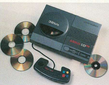
Amiga CD32: Die Spielekonsole basiert auf einem Amiga 1200 mit AGA-Chipsatz und einem CD-ROM-Laufwerk gestiftet von: GTI
